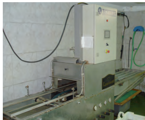
Equipo de lavado de setas
