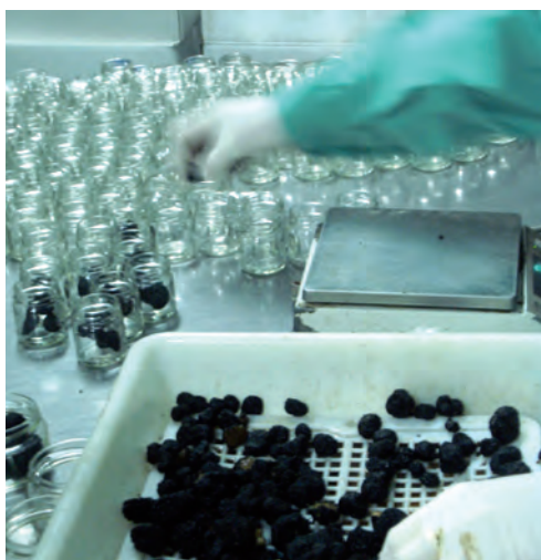
Proceso de envasado y control del contenido neto de producto final
